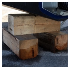
Kjølstøtte motorbåt Min. 4"x 4" trevirke
